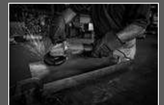
Biztonsági kuplung az esetlegesen fellépő visszarúgás effektus elkerülésére
